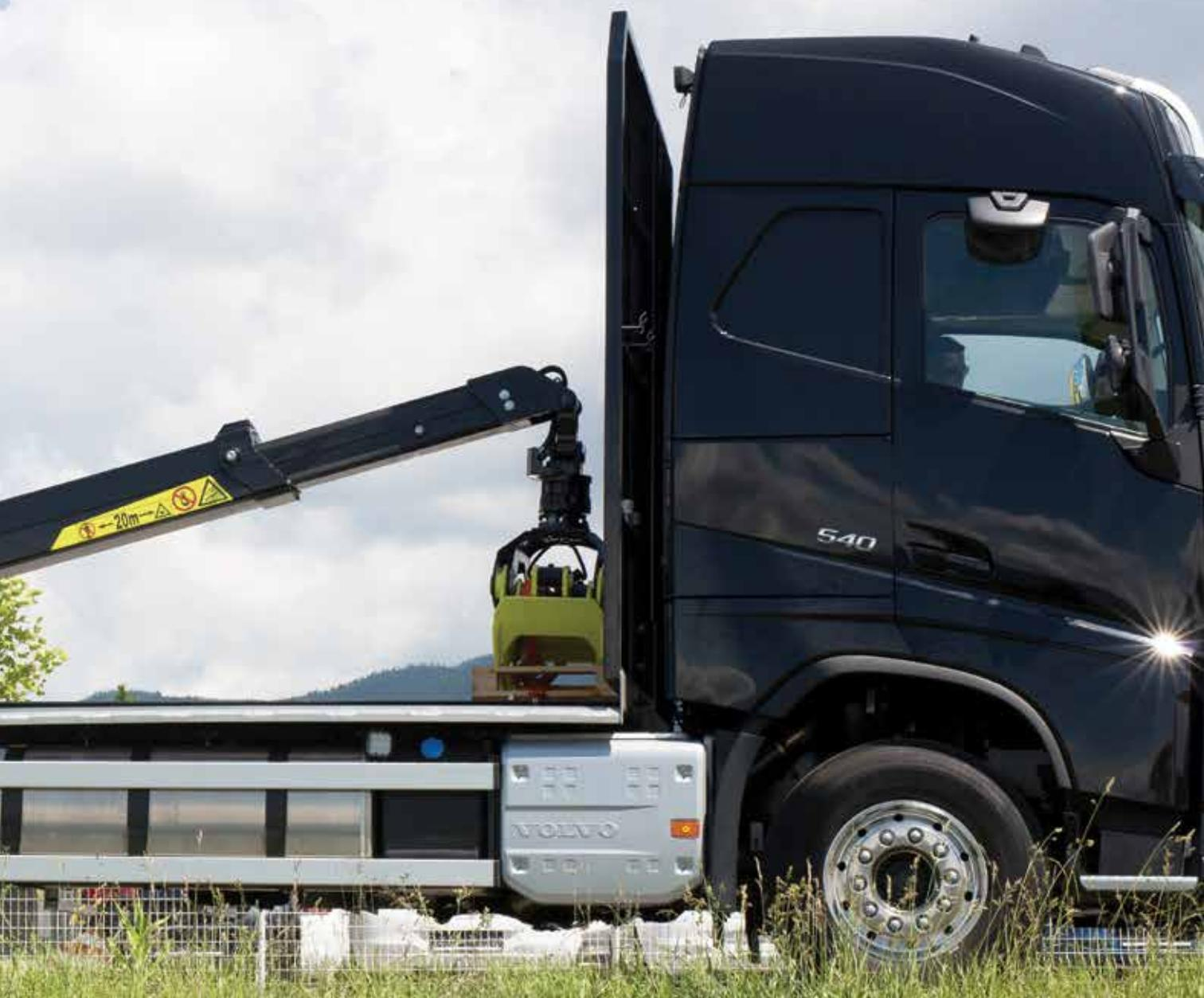
Манипуляторы «К» отличаются своей мощностью и надежностью. Во время транспортировки эти манипуляторы можно парковать вытянутыми над грузом, на погрузочной площадке или даже над кабиной грузовика. Силовая связь между основной и внешней стрелой позволяет дополнительно увеличить подъемный момент в горизонтальном положении. К-манипуляторы с разнообразными стреловыми системами, одинарным или двойным телескопическим выдвижением отвечают большинству
