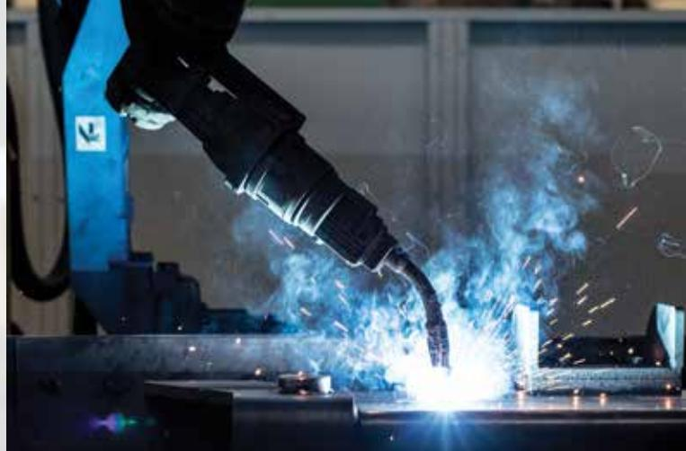
🇷🇺 Колонна приваривается к основанию сварным швом, который затем подвергается процедуре специальной очистки и проверке ультразвуком. Данный тип шва отличается высочайшим качеством и позволяет колонне реагировать на нагрузки так, как если бы она была цельно-литой. Эта современная конструкция является тонкой, но при этом имеет достаточные габариты, что обеспечивает лучшую устойчивость крана к
