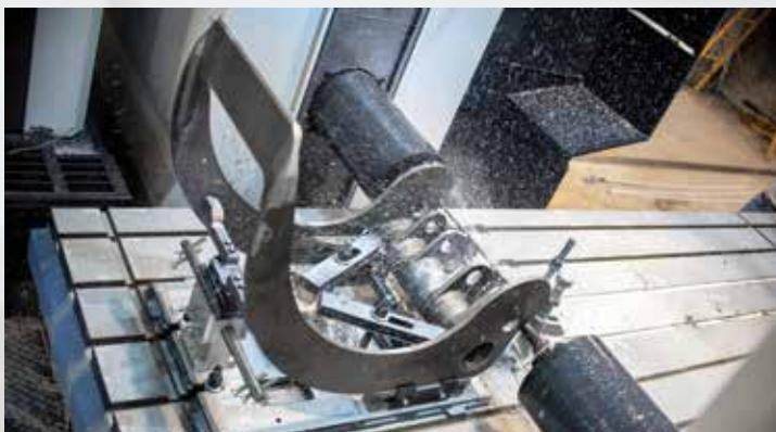
🇷🇺 Первоклассная обработка грейферов на двухшпindelном многоцелевом обрабатывающем станке DBD
