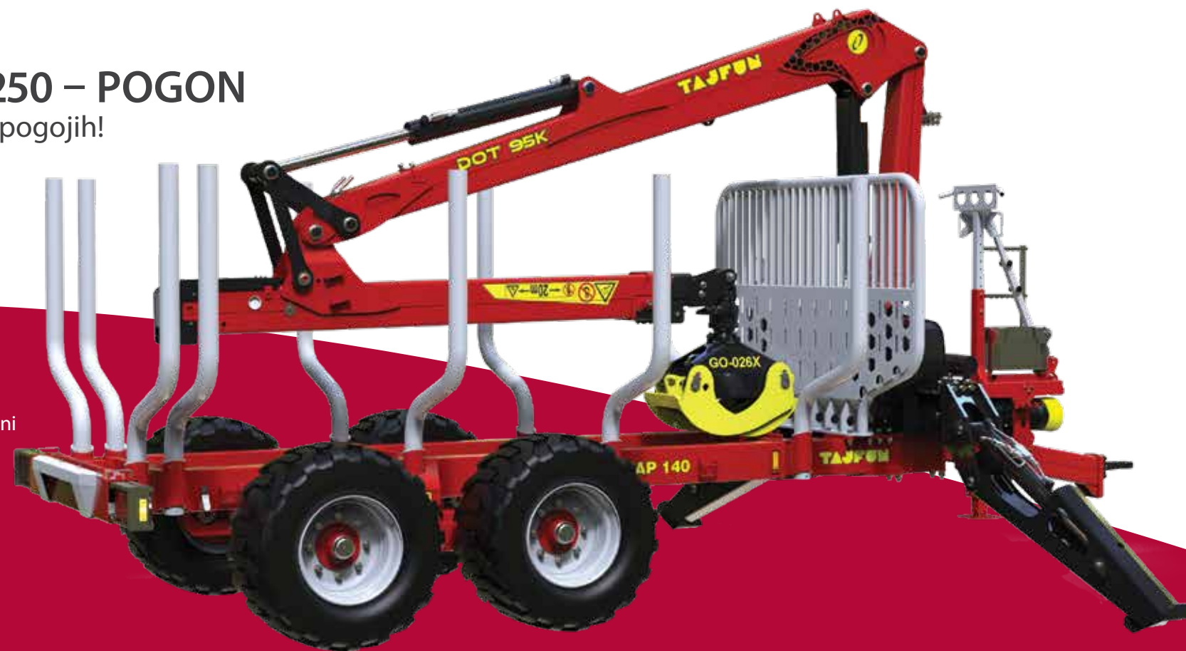
Kolo (pnevmatika, platišče in zaščita ventila) 500/50-17/18PR
