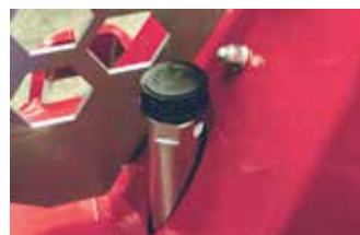
Ölbehälter mit Einfüllstutzen an der äußeren Seite des Rahmens.
