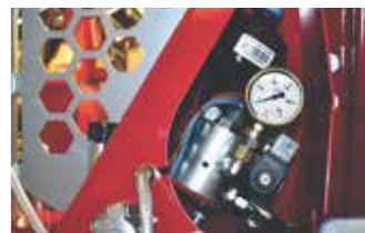
Das elektrohydraulische System ist in die Bauform integriert und somit vor Schäden und Wettereinflüssen geschützt.
